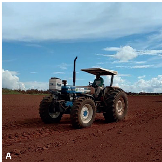
Figura 2. Semeadura à lanço usando a semeadora / adubadora MS 40-CR IKEDA (A), padrão de distribuição das sementes no solo (B).
