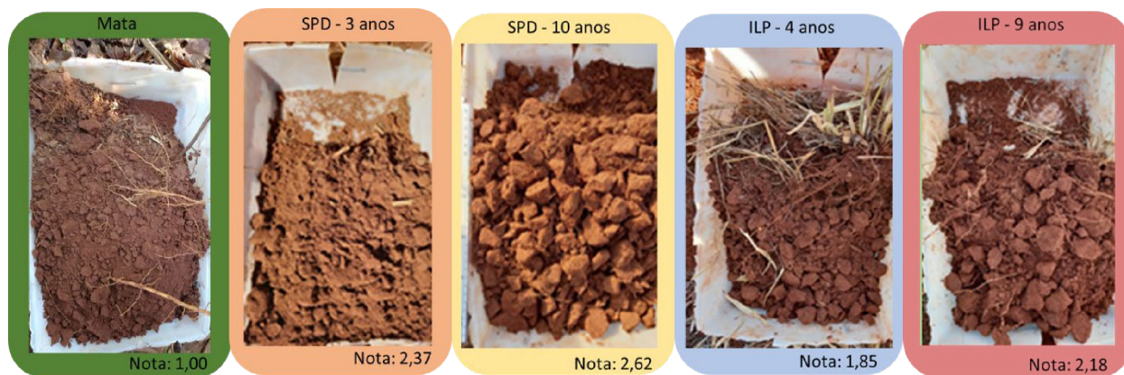
Figura 4. Amostras de agregados de um Latossolo Vermelho sob diferentes sistemas de produção agrícola e histórico de instalação no período de entressafra em Rio Verde/GO.
